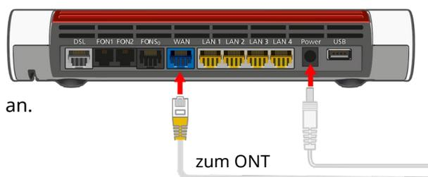
Besitzt die Fritz!Box keine blaue WAN-Buchse (z.B. 7530 oder 7560), verwenden Sie bitte für den Anschluss die Buchse LAN1.
