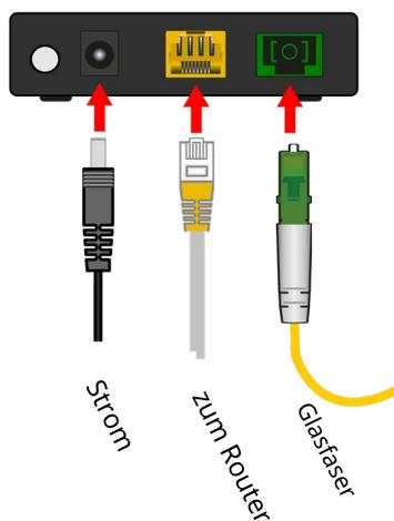
Verwenden Sie dafür bitte ein hochwertiges Netzkabel (z.B. Cat-6) und stellen Sie unbedingt eine direkte Verbindung zwischen dem ONT/Medienwandler und der Fritzbox her. Es dürfen sich keine anderen Netzwerkgeräte wie z.B. Hubs, Switches etc. zwischen den beiden Geräten befinden.
